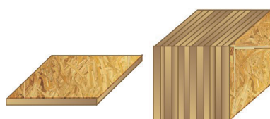
①ヨシストランドボード単板としての利用、および積層した厚板・柱等の部材としての利用
