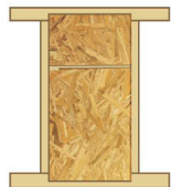
②単板を木造軸組みに釘打ちした耐力壁としての利用
